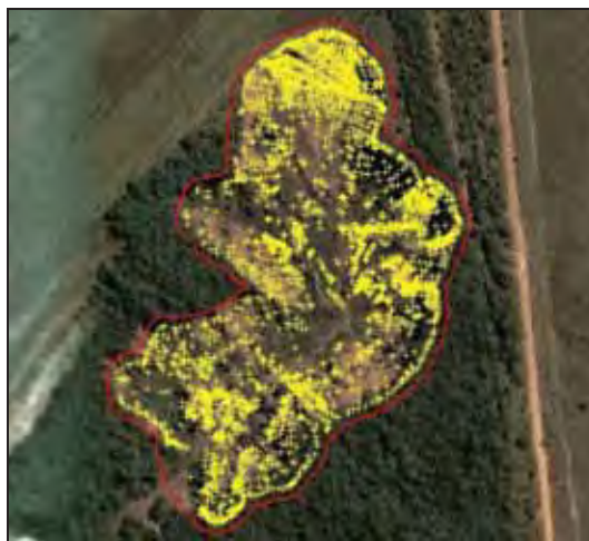
Figura 46 – Distribuição dos pontos levantados na voçoroca de Costa Rica.
