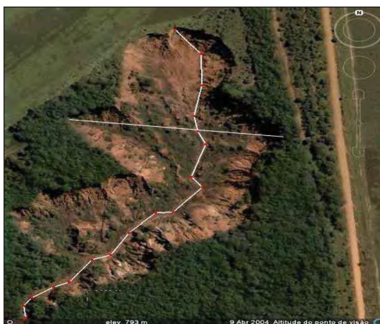
Figura 33 – Principal voçoroca localizada à montante do reservatório da PCH de Costa Rica (MS).
