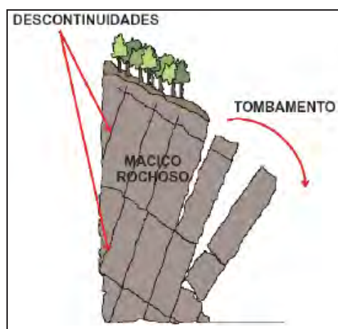
Figura 3 – Representação esquemática do processo de tombamento (Oliveira e Brito, 1998).
