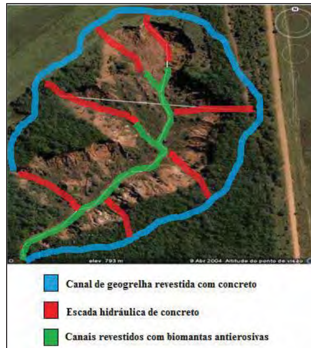
Figura 56 – Esquema do sistema de drenagem proposto para a voçoroca de Costa Rica.
